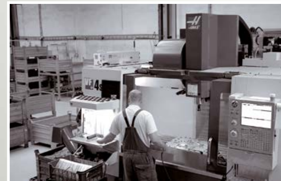
výroba baterií - CNC obráběcí centrum HAAS
